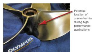
été effectuée. Le point de défaillance le plus courant sur les hélices se situe là où la pale rejoint le moyeu. Les fissures peuvent toutefois survenir partout le long de l'axe de la pale jusqu'au rayon du moyeu.
