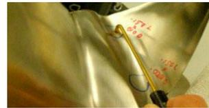
Il est également possible d'utiliser une sonde de type « fingertip ».
